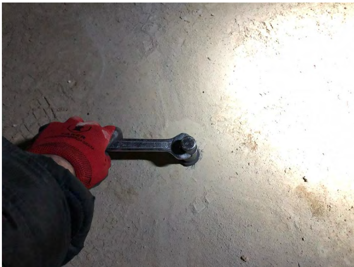
Рис. 4.2.5. Установка тяги прибора «ПОС-50МГ4»
