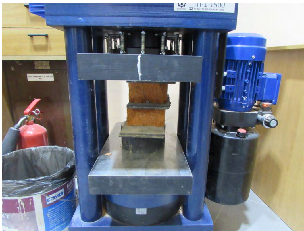
Рис. 4.7.2. Установка кирпича в испытательный пресс перед испытанием
