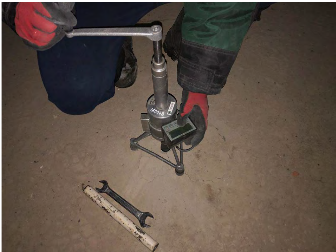
Рис. 4.2.7. Проведение испытания прибором «ПОС-50МГ4»
