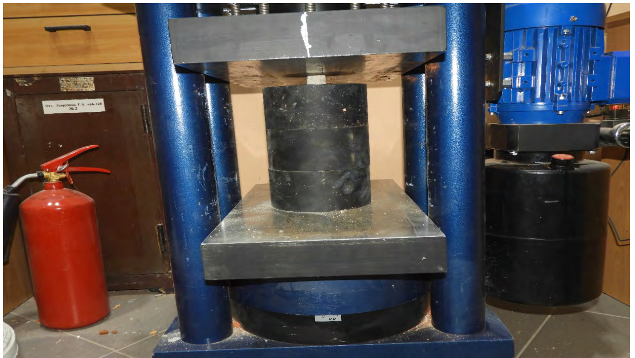
Рис. 4.8.3. Определение прочности образца раствора из швов кирпичной кладки
