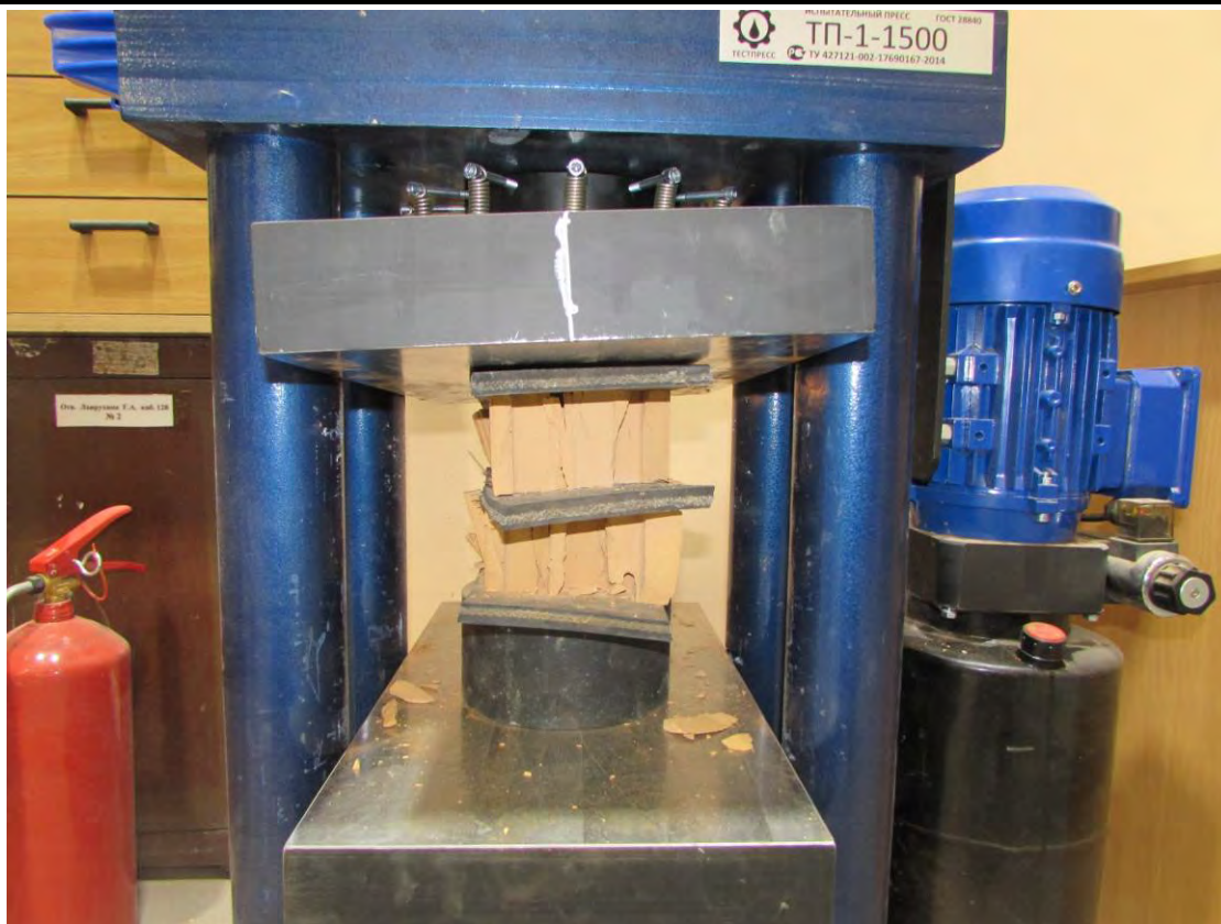
Рис. 4.7.3. Вид испытываемого образца после проведения испытания на изгиб
